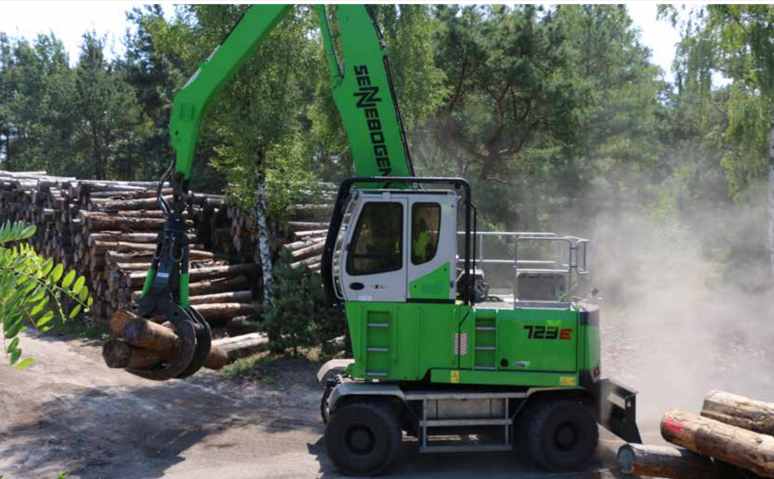
SENNEBOGEN Holzgreifer SGH SENNEBOGEN timber grab SGH
