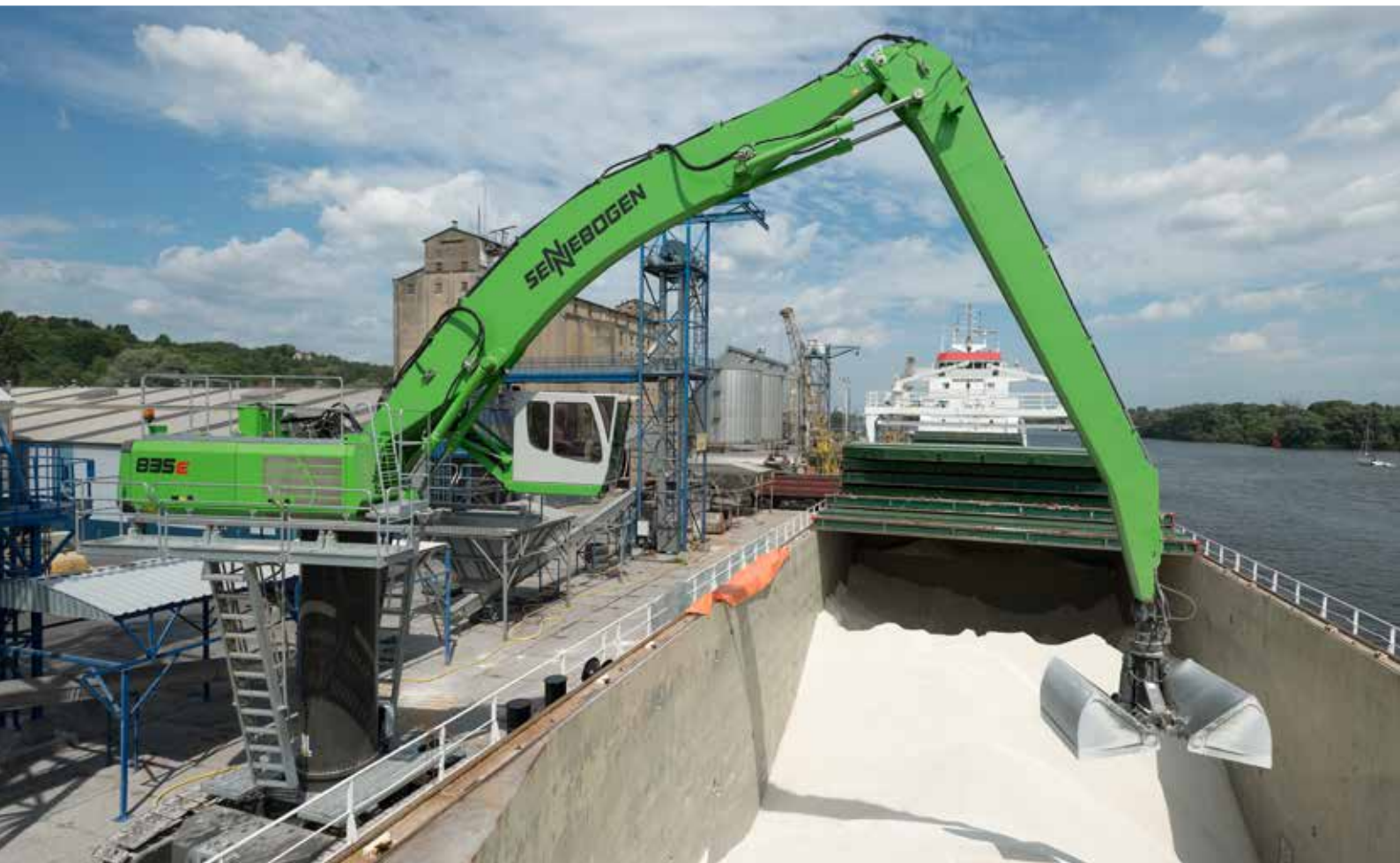
SENNEBOGEN Zweischalengreifer SGZ SENNEBOGEN clamshell grab SGZ
